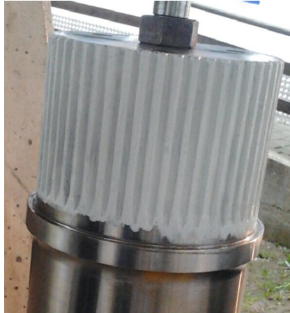
Illustrazione 4: Albero dentato correttamente lubrificato
