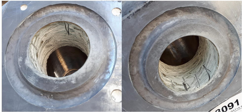
Illustrazione 1: Applicazione di una quantità sufficiente di lubrificante per protezione anticorrosione base
