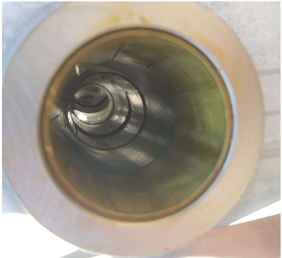
Illustrazione 3: Strato di corrosione o strato di lubrificante protettivo rimosso senza residui
