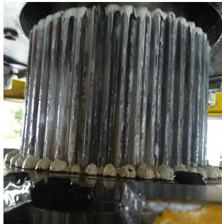
Illustrazione 5: Albero dentato lubrificato impropriamente
