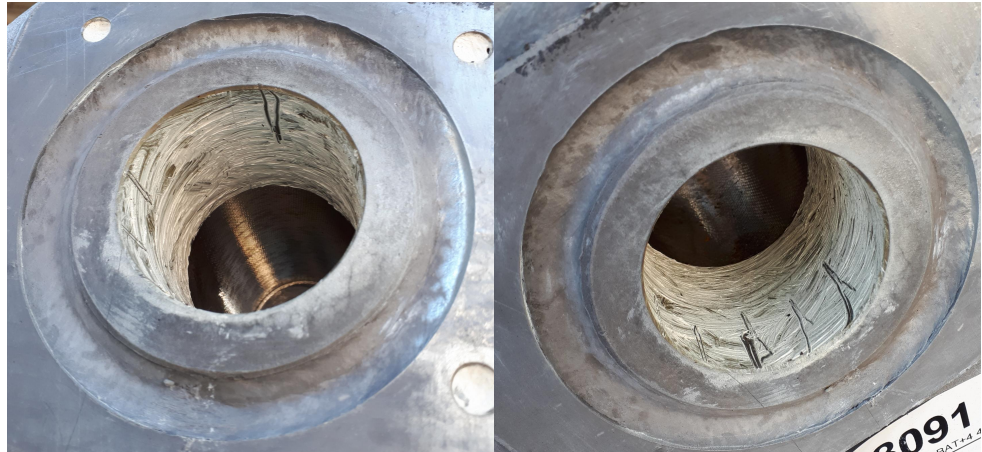
Abb. 1: Ausreichend Schmiermittel für Grundkorrosionsschutz aufgetragen
