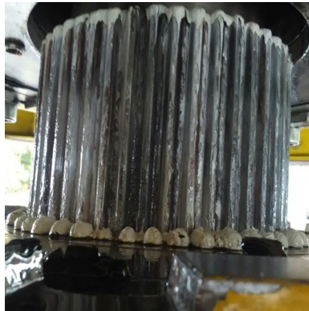
Abb. 5: Falsch geschmierte Zahnwellenverbindung
