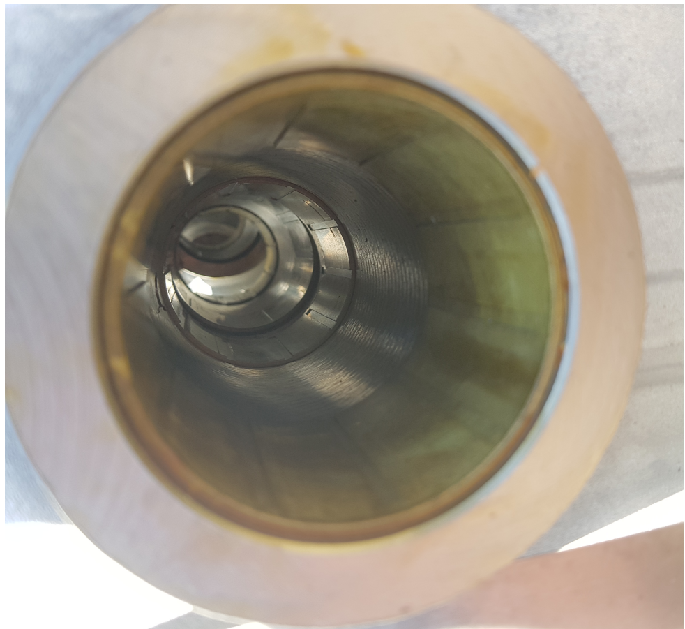
Abb. 3: Korrosionsschicht oder schützende Schmierfilmschicht rückstandslos entfernt
