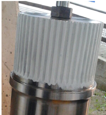
Abb. 4: Richtig geschmierte Zahnwellenverbindung
