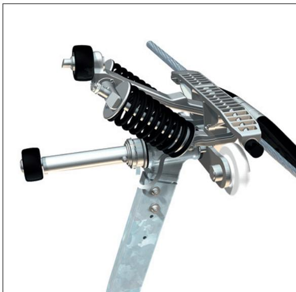
**Vantaggi** Le due molle elicoidali sono disposte in parallelo per fornire con la loro configurazione la massima sicurezza. Anche in caso di avaria di una molla la forza di chiusura residua garantisce il serraggio minimo per proseguire in sicurezza il viaggio.
