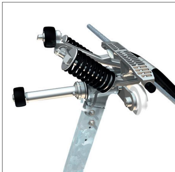
**Vorteile** **Parallel angeordnete Schraubenfedern** sorgen durch ihre redundante Anordnung für **höchste Sicherheit**. Selbst bei Ausfall einer Feder kann ein Klemmenrutschen zuverlässig ausgeschlossen werden.
